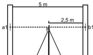
Установить лазерный построитель плоскостей на расстоянии 0,5-0,7 м от стены и нанести, как указано выше, те же отметки. Если разности  $(a1-a2)$  и  $(b1-b2)$  не
