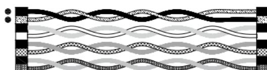
Liegt der Verdrahtungsfehler **Vertauschung** vor, sind die Pins von **einem** Adernpaar falsch untereinander verbunden.
