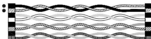
Als de bedradingsfout **verwisseling** wordt geconstateerd, zijn de pins van **één**aderpaar onderling verkeerd verbonden.
