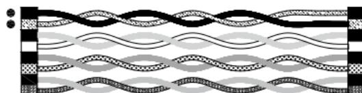
Se l'errore di cablaggio è uno **scambio**, i pin di **una** coppia di connettori sono collegati in modo errato.
