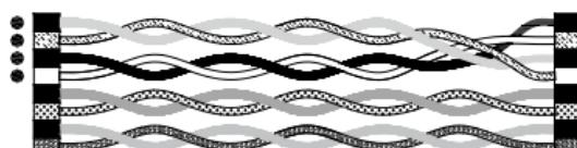
Se l'errore di cablaggio è un **incrocio**, i pin di **due** coppie di connettori sono collegati in modo errato.
