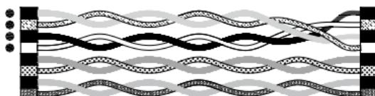
Als de bedradingsfout **kruising** wordt geconstateerd, zijn de pins van **twee**aderparen onderling verkeerd verbonden.
