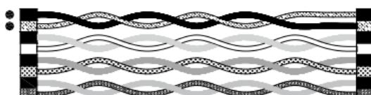
Cuando se señala el error de cableado **conexión equivocada**, los pines de **un** par de conductores están mal conectados entre sí.
