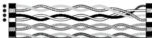
Hvis der er tale om ledningsføringsfejlen **krydsning**, er pindene fra **to** ledningspar forbundet forkert med hinanden.
