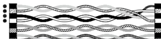
W przypadku błędu okablowania **skrzyżowanie** styki **dowóch** par żył są nieprawidłowo podłączone.
