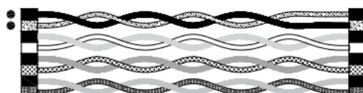
En cas de l'erreur de câblage **permutation**, les broches d'**une** paire de brins ne sont pas correctement raccordée entre elles.
