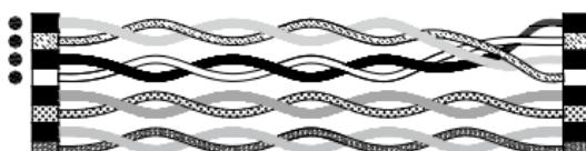
Cuando se señala el error de cableado **cruce** está indicando que los pines de **dos** pares de conductores están mal conectados entre sí.
