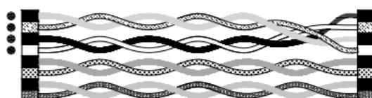
Liegt der Verdrahtungsfehler **Kreuzung** vor, sind die Pins von **zwei** Adernpaaren falsch untereinander verbunden.
