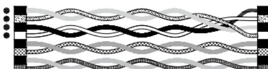
Kablo döşeme hatası **çaprazlama** söz konusu olduğunda, **iki** iletken çiftinin Pin'leri yanlış bağlanmıştır.
