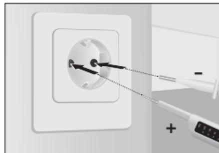
Ana cihazı (+) sağ elinize alınır ve ikinci kontrol ucunu (-) sol elinize. Ölçüm uçlarını kontrol etmek istediğiniz elektrik kontaklarına (ms. kablo, priz vs.) sürüneniz.
