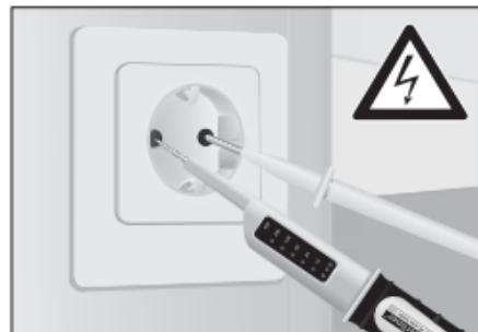
Si existe tensión se encienden todos los LEDs hasta la tensión medida, así como los LED de positivo y negativo.
