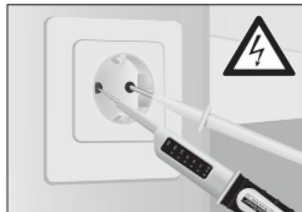
In presenza di corrente, si illuminano tutti i LED fino alla tensione misurata e i LED Più e Meno.
