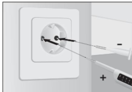
Tome el aparato básico (+) en la mano derecha y la segunda punta de comprobación (-) en la mano izquierda. Aplique las puntas de medición en los contactos a comprobar (p. ej. cables, enchufes, etc.).
