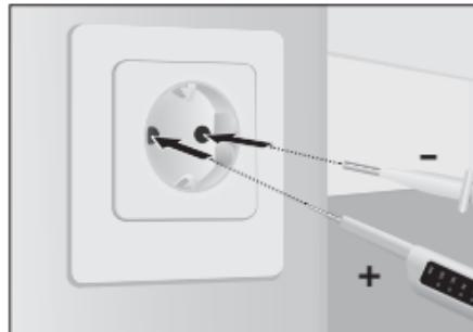
Ta basisapparatet (+) i den høyre hånd og den andre testspissen (-) i venstre hånd. Før nå målespissene til kontaktene som skal testes (f.eks. ledning, stikkontakt, etc.).
