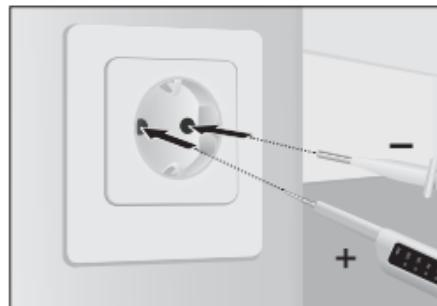
Візьміть основну частину приладу (+) у праву руку, а другий випробувальний щуп (-) – у ліву. Піднесіть вимірювальні щупи до контактів, що перевіряються (наприклад, електропроводки, розетки тощо).
