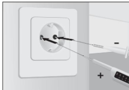
Ota laite (+) oikeaa käteen ja toinen mittauskärki (-) vasempaan käteen. Kosketa mittauskärjillä testattavaa kohdetta (esim. kaapeli, pistorasia jne.).
