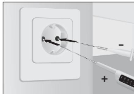
Vezměte základní přístroj (+) do pravé ruky a druhý zkušební hrot (-) do levé ruky. Přiložte měřicí hrotů ke zkoušeným kontaktům (např. kabelu, zásuvce, atd.).
