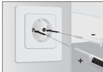
Neem het basisapparaat (+) in de rechterhand en de tweede testpunt (-) in de linkerhand. Beweeg nu de meetpunt naar de te controleren kabel (bijv. leiding, contactdoos, enz.).
