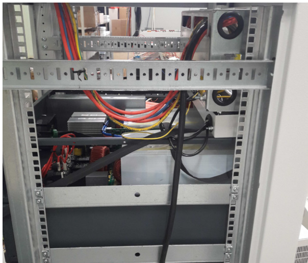
Рисунок 19. Крепление кабелей в изделии
