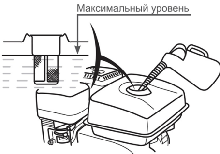
Рис. 8 Максимальный уровень топлива в топливном баке
