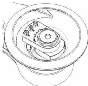
2. Masina konfiguratsioon kaitseketta või vahetallaga kasutamisel.
