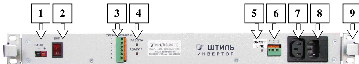
Рисунок 1.3 - Инвертор ШТИЛЬ серии (STS). Передняя панель 1 – разъём «ВХОД»; 2 – тумблер включения инвертора; 3 – клеммные соединители «Сигнализация»; 4 – светодиодные индикаторы «Работа» и «Авария»; 5 – светодиодный индикатор «ON/OFF LINE»; 6 – клеммные соединители «1 2 3»; 7 – разъём «Выход~220В»; 8 – разъём «Вход~220В» с держателем предохранителя; 9 – крепёжные отверстия (4шт.).
