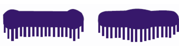
Образцы с неправильным распределением материала в факеле
