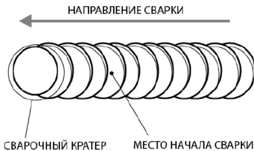
Рис. 11.1.2. Начало сварки при смене электрода.
