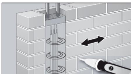
ZOOM-näppäin painettuna laitteen herkkyys kasvaa (24:stä 1 000:en V AC). Siten voi jännitekentän paikallistaa kauempaa samalla kun laitetta liikutetaan tarkistettavan alueen yli.
