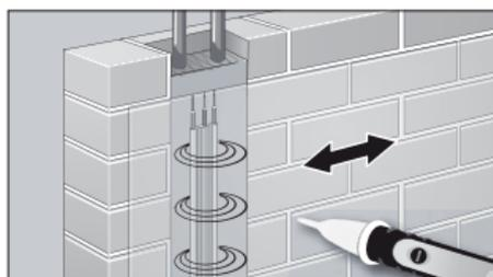
Når ZOOM-knappen er trykket ind, øges apparatets følsomhed (24 VAC til 1000 VAC). På denne måde kan man lokalisere spændingsfelter på større afstand ved at bevæge apparatet hen over det pågældende område.
