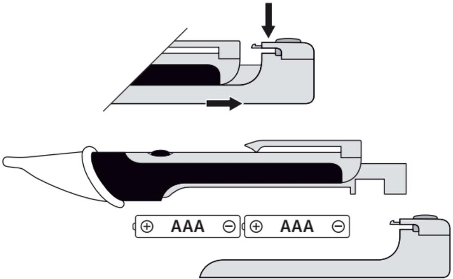
Das Gerät ist nach Einsetzen der Batterien direkt betriebsbereit. Es verfügt über keinen gesonderten Ein-/Aus-Schalter und ist somit immer aktiv.
