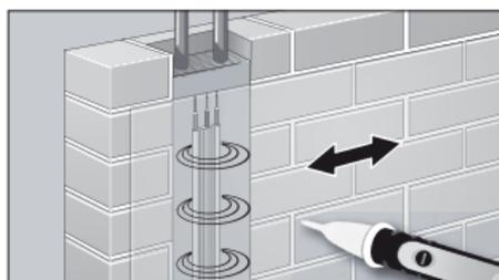
Przy wciśniętym przycisku zoom zwiększa się czułość urządzenia (24 VAC do 1000 VAC). Można wtedy lokalizować pola napięcia na większą odległość, poprzez poruszanie urządzenia nad badanym obszarem.
