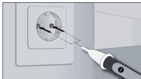
Așezați vârful detector pe zona de verificat (de ex. cablu, priză, etc.).
