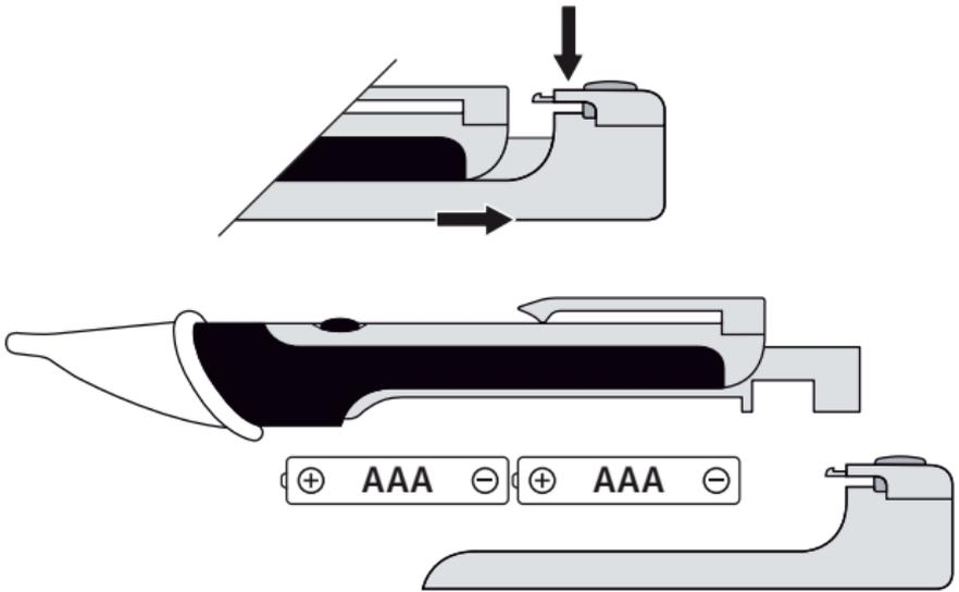
**!** Het apparaat is direct na het plaatsen van de batterijen klaar voor gebruik. Het apparaat heeft geen aparte aan-/uitschakelaar en is dus altijd actief.
