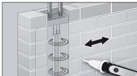
Натискання кнопки ZOOM підвищує чутливість приладу (від 24 до 1000 В змінного струму). Таким чином можна виявляти електричні поля на більшій відстані при пересуванні приладу по ділянці, що перевіряється.
