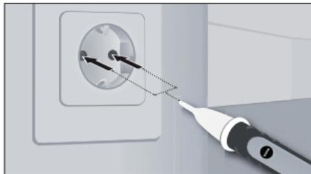
Coloque a ponta do detector sobre a área a controlar (p. ex. cabo, tomada, etc.).
