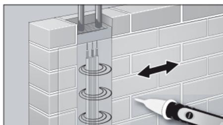
При натиснат ZOOM-бутон чувствителността на устройството се повишава (24 VAC до 1000 VAC). Така могат да се локализират полета напрежение на по-голямо разстояние, като устройството се движи над проверяваната зона.
