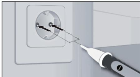
Plaats de detectorpunt op het te controleren bereik (bijv. kabel, contactdoos, enz.).
