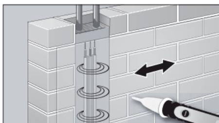
Med intryckt ZOOM-knapp ökar apparatens känslighet (24 VAC till 1000 VAC). Därmed kan spänningsfält lokaliseras på större avstånd när apparaten förs över det område som ska testas.
