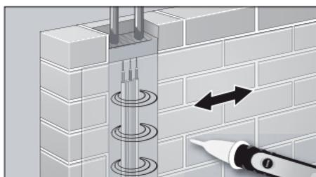
Pomocí stisknutého tlačítka ZOOM se zvýší citlivost přístroje (24 VAC až 1000 VAC). Napěťová pole na lze na větší vzdálenost lokalizovat tak, že se přístrojem pohybuje nad měřenou oblastí.
