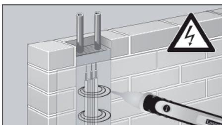
Pinge olemasolu korral süttib detektoritipp ja kõlab signaal.
