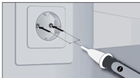
Sæt detektorspidsen på det område, der skal prøves (fx kabel, stikkontakt, osv.).
