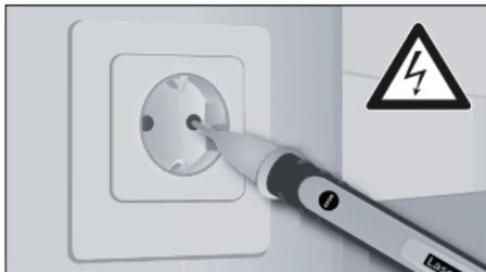
Якщо напруга є, засвітиться щуп і пролунає звуковий сигнал.
