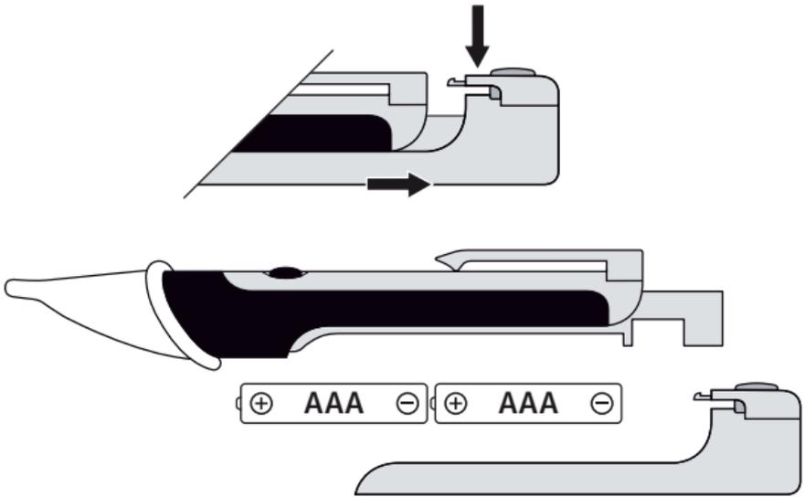
**!** Прибор готов к эксплуатации сразу после установки батарей. У него нет отдельного выключателя (Вкл./Выкл.), и поэтому он всегда готов к работе.
