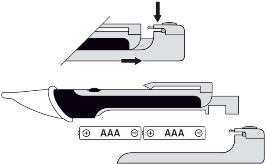
Після вставлення батарейок прилад відразу готовий до експлуатації. Він не має спеціального вимикача і тому завжди увімкнений.
