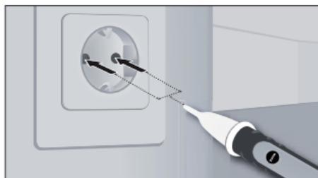
Mettere la punta del rilevatore sulla zona da controllare (p.e. cavo, presa, ecc.).
