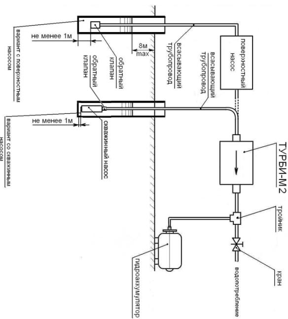
вариант с поверхностью насосом
