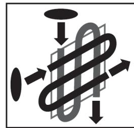
Регулярно проверяйте состояние сетевого кабеля. Не допускайте повреждения изоляции, загрязнения, чрезмерных тянувших и изгибающих нагрузок.
