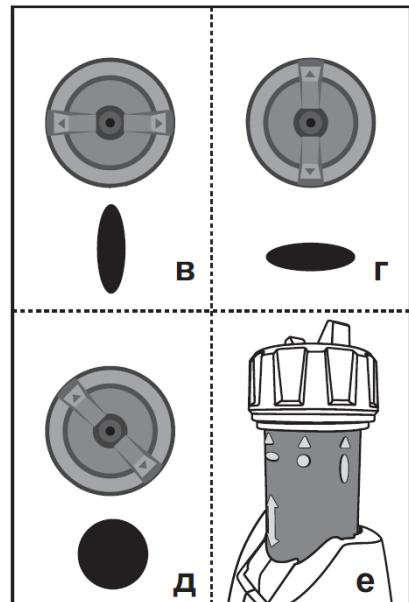
При пробной окраске определите необходимую скорость ведения распылителя для равномерной окраски и расход материала, во избежание, при большой скорости и недостаточном расходе, неравномерного покрытия; а при низкой скорости и избыточном расходе – потоков материала. Регулировка расхода материала осуществляется вращением регулятора 1.
