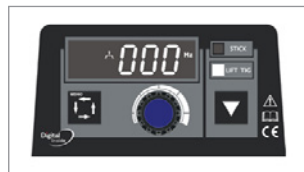
Схема 8: Регулирование основного тока без импульса постоянного тока в режиме LIFT TIG
