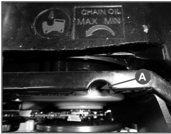
Рис. 11 Положение регулировочного винта подачи масла
