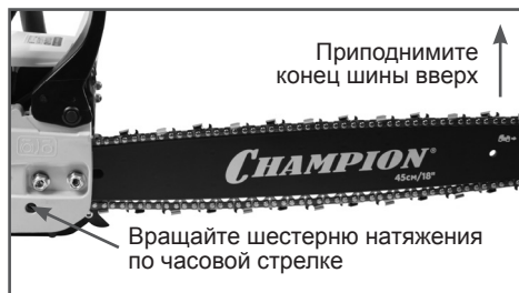
Рис. 5 Регулировка натяжения цепи
