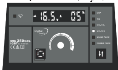
Рис. 5: Выбрана функция регулировки длины дуги. Кнопка 1 выбор данных (menu)
