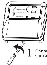
1 Ослабьте винт на нижней части приемника
