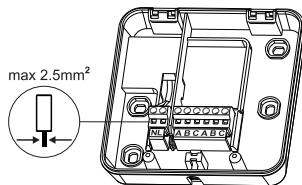
4 Ослабьте винты на клеммах. Правильно подключив базу, зажмите винты
