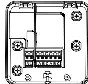
6 Зажмите винт в нижней части приемника после правильной установки крышки и убедившись в правильном подключении
