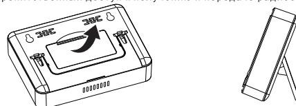
Если Вам необходимо закрепить терморегулятор на стене, то используйте предоставленные размеры для отверстий. Просверлите два отверстия в стене и затяните винты, обеспечивая расстояние 81,5мм между отверстиями; Закрепите заднюю крышку терmostата, поместив его на головку винта.
